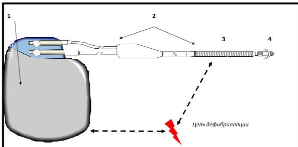
**Рисунок VI.1** Схема современных ИКД. Устройство состоит из титанового корпуса (1) и внутриседечного электрода (2). Цепь разряда ИКД заключена между корпусом устройства и катушкой (3), находящейся на электроде. С помощью дистального кончика электрода (4) осуществляется детекция аритмических событий и проведение антитахи- и антибради-электрокардиостимуляции.
