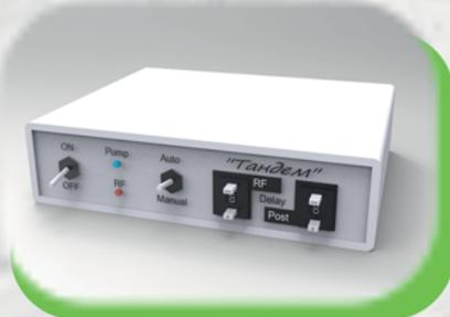
Симулятор «Крио Тестер», имитирующий работу крио катетера и позволяющий выявлять неисправности в крио консолях и катетерах.
